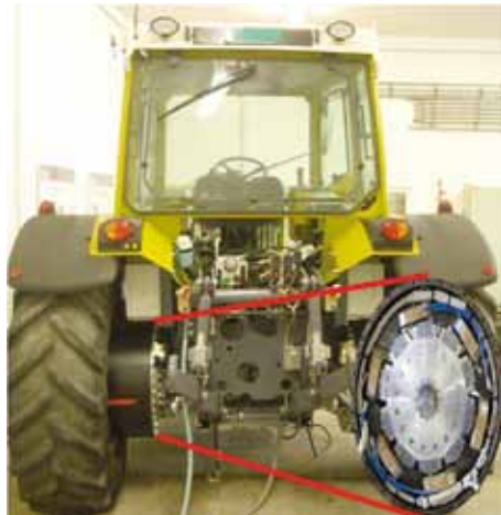
Traktor mit Hybridantrieb (dieselelektrischer Generator plus Radnabenmotoren in den Hinterrädern)
