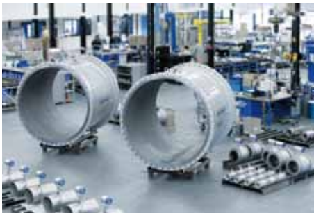
Ein kleiner Ausschnitt aus dem KROHNE-Produktportfolio: Magnetisch-induktive Durchflussmessgeräte für Rohrleitungen von 2,5 bis 3000 mm Nennweite.
